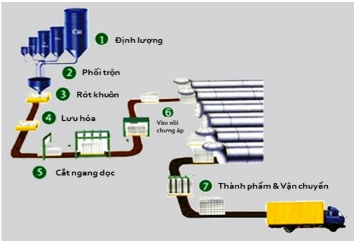
Hình 3.2: Sơ đồ công nghệ sản xuất gạch bê tông khí chưng áp
